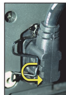
Разъем с поворотом на 90° Фиксатор должен быть защелкнут с левой стороны
