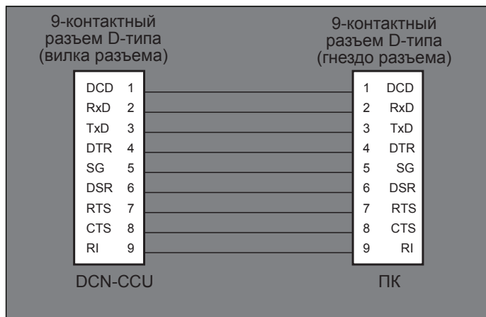
рисунок 8.27: Соединение DCN-CCU с ПК
