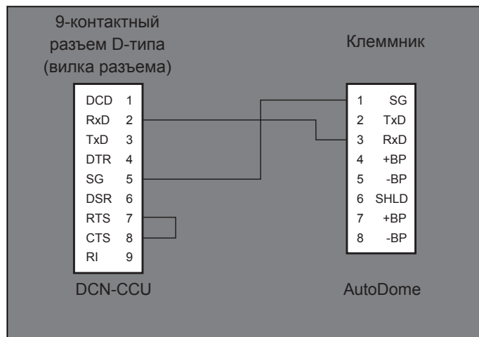
рисунок 8.18: Соединение DCN-CCU с AutoDome
