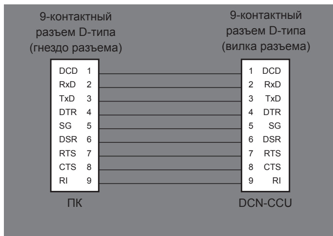
рисунок 8.20: Соединение ПК с DCN-CCU
