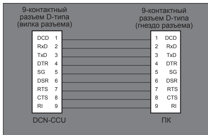
рисунок 8.24: Соединение DCN-CCU с ПК
