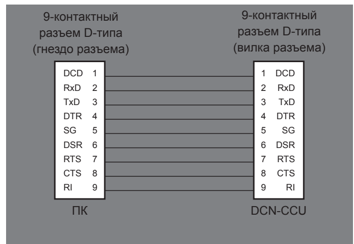
рисунки 8.17: Соединение ПК с DCN-CCU
